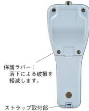
保護ラバー：落下による破損を軽減します。
