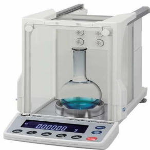
仕切板を外した状態でも除電可能
