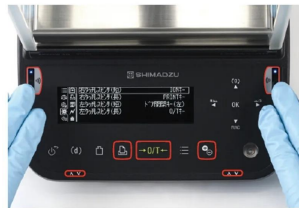
株式会社 島津製作所 画像は、タッチレスセンサの使用イメージです。
