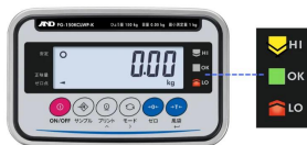
バック詰め作業（少ない・ちょうどよい・多い）ランク分け作業 決められた重さに対して 『少ない（LO）・ちょうどよい（OK）・多い（HI）』という 判断をコンパレータライトで直感的に判断できることで作業効率 が大幅に向上します。 その種の範囲（上下閾値）は最大10個まで登録が可能です。
