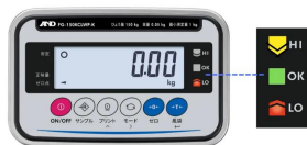
バック読め作業（少ない・ちょうどよい・多い）ランク分け作業 決められた重さに対して 『少ない（LO）・ちょうどよい（OK）・多い（HI）』という 判断をコンパレータライトで直感的に判断することで作業効率が 大幅に向上します。 その種の範囲（上下閾値）は最大10個まで登録が可能です。
